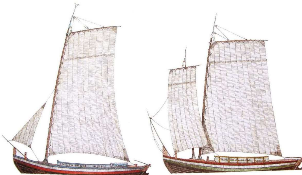
Croqui de Lev Smarcevski, extraído da página 47A do seu livro “Graminho”, mostrando duas variações tipológicas do saveiro. O segundo, com dois mastros, o menor à proa, já não é mais avistado no Recôncavo.
